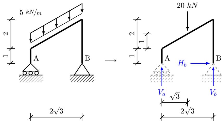
**Figura 1.14:** Diagrama de cuerpo libre de la estructura para el caso de carga (b).
