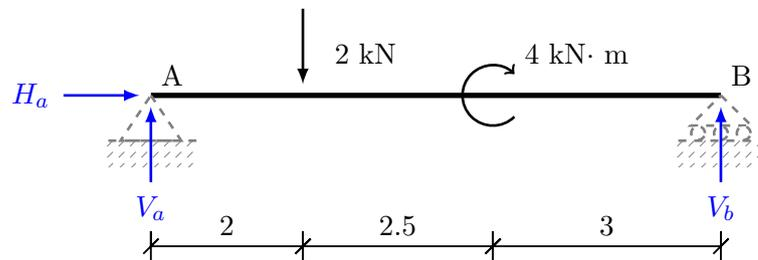
Figura 1.6: Estructura, incluyendo las reacciones ejercidas por los apoyos.
