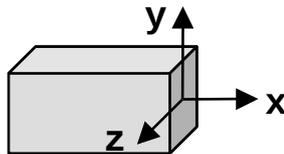
Criterio de ejes de coordenadas asumido para denotar los esfuerzos de la tabla superior: X eje longitudinal, Y y Z suelen coincidir con los ejes principales de inercia de la sección.
