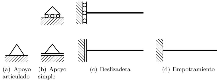
**Figura 1.1:** Tipos más habituales de restricciones: (a) Apoyo simple: se restringe el desplazamiento en una dirección, (b) apoyo articulado: se restringen todos los desplazamientos, (c) deslizadera: se restringe el giro y el desplazamiento en una dirección, (d) empotramiento: todos los giros y desplazamientos restringidos.
