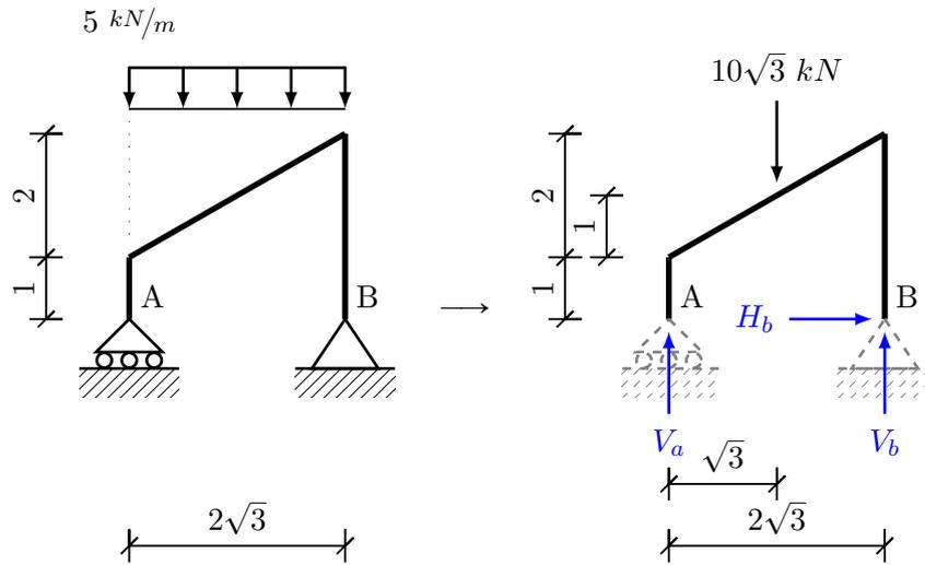
**Figura 1.15:** Diagrama de cuerpo libre de la estructura para el caso de carga (c).
