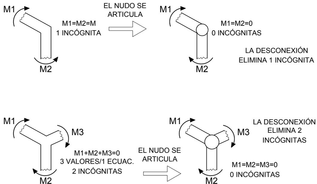
Figura 1.2: Ejemplos de desconexiones en nudos.
