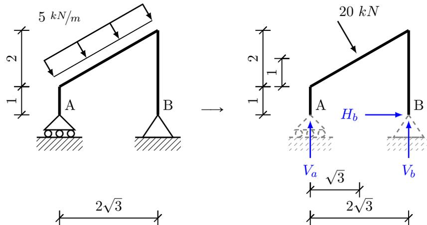
**Figura 1.13:** Diagrama de cuerpo libre de la estructura para el caso de carga (a).
