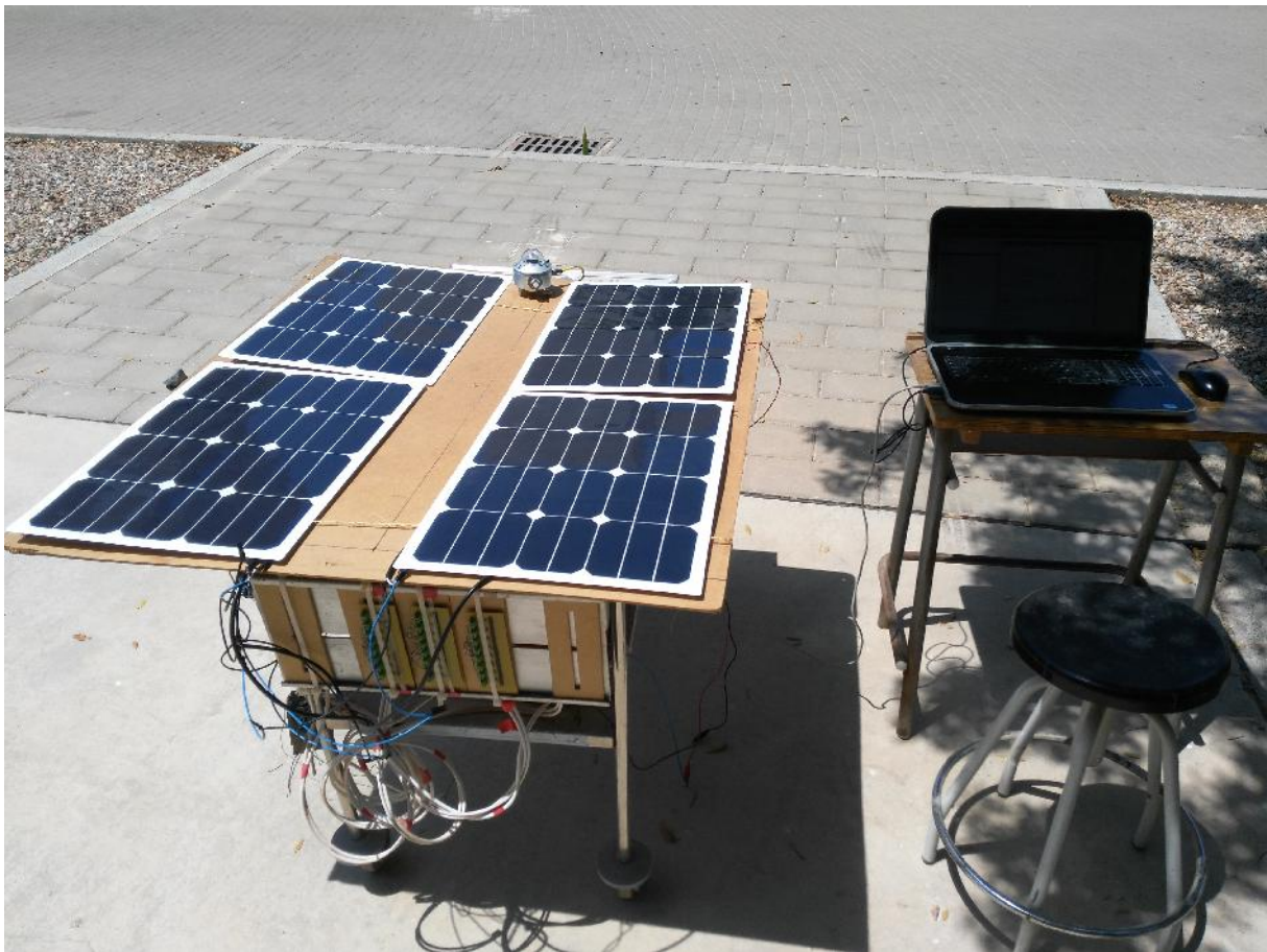
Figura 5.12: Disposición de los módulos FV Techno Sun Flex 30 W para realizar los ensayos, nótese la posición coplanaria del piranómetro en la parte superior de la imagen
