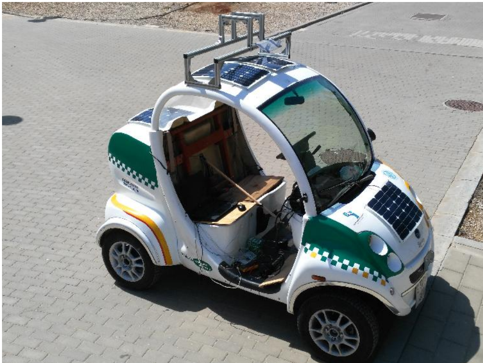
Figura 6.14: Resultado final de la instalación en el vehículo de los módulos fotovoltaicos, vista lateral del vehículo
