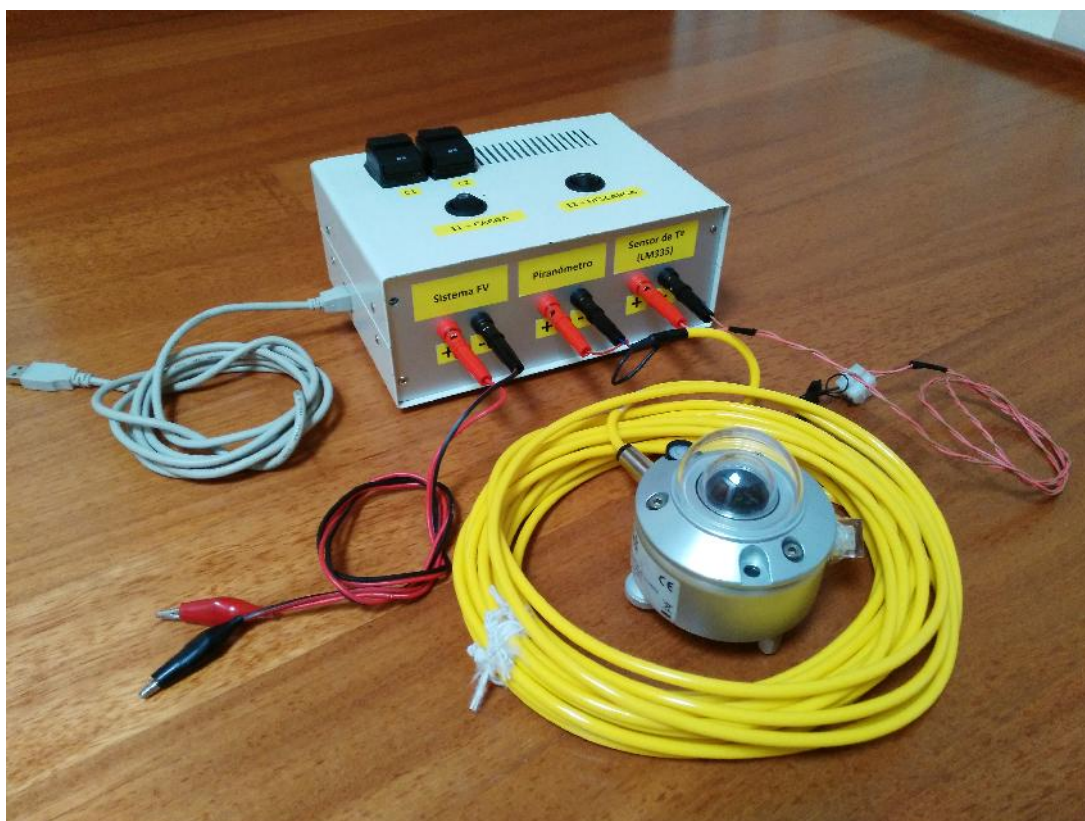
Figura 1.4: Equipo de medida para caracterización de curvas Tensión-Intensidad de módulos fotovoltaicos
