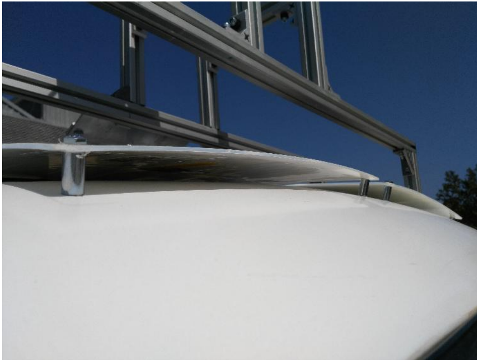
Figura 6.13: Detalle de los separadores utilizados para instalar los módulos en el vehículo
