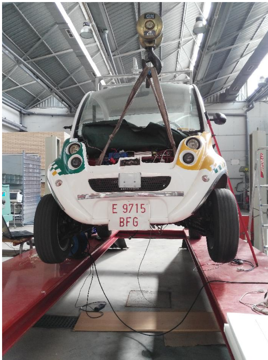
Figura 1.3: Vehículo eléctrico en cuestión con el tren de tracción suspendido, ensayos de descarga de baterías
