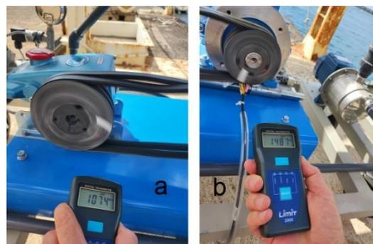
Figura 2. Fotografía de medición de frecuencia de rotación de las poleas (rpm). a) accionada; b) motriz
