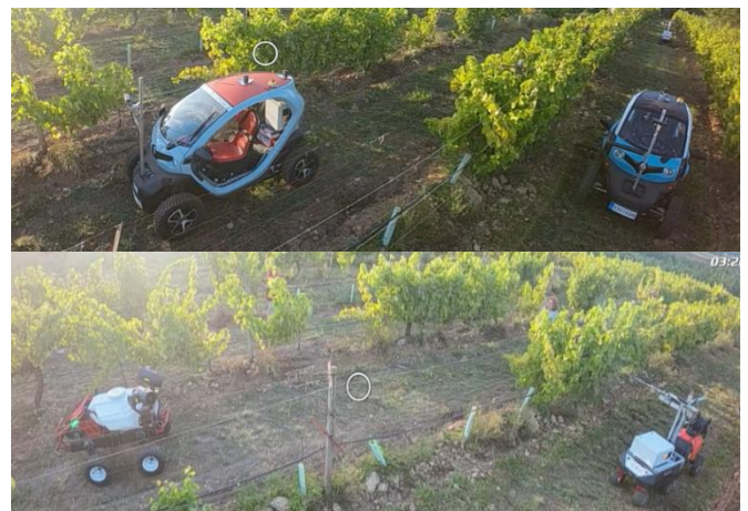
Figura 2: Arriba: Los dos robots de inspección en acción durante la tarea de detección. Abajo: Los dos robots de tratamiento en funcionamiento.
