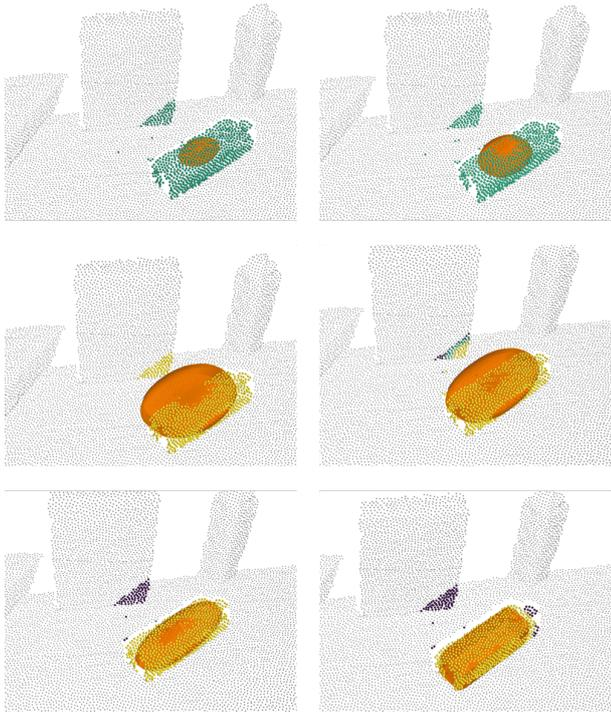
Figura 2: Evolución del ajuste de forma durante la optimización. La estimación de la forma (en naranja) se ajusta progresivamente al objeto a medida que se refinan las probabilidades de pertenencia. Los puntos con alta probabilidad aparecen en amarillo; los outliers en púrpura oscuro.
