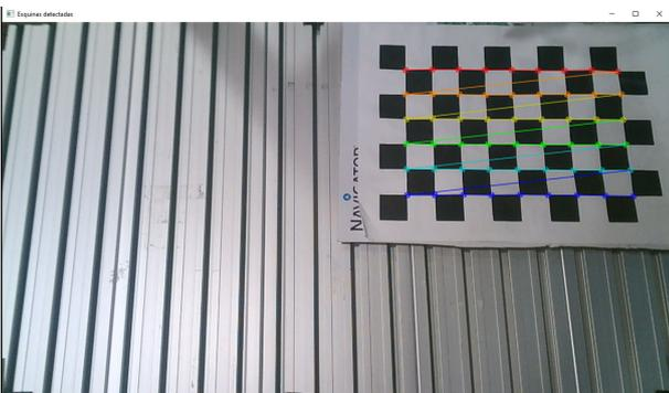
Figura 4: Proceso de calibración mediante el tablero de ajedrez.
