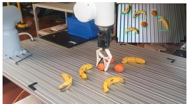
Figura 7: Aplicación de Pick & Place utilizando la cámara calibrada.
