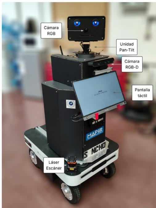
Figura 1: Robot de servicio Sancho. Está equipado con dos escáneres láser Hokuyo usados para localización y navegación, y sensores RGB y RGB-D para detección de usuarios.
