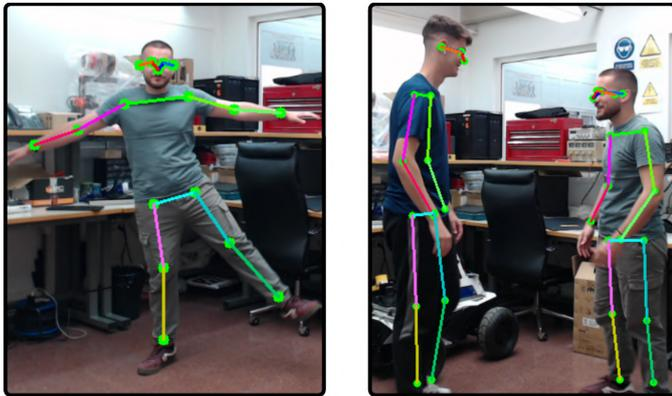
Figura 3: Detección de usuarios. La red Movenet detecta a los usuarios y permite calcular su orientación.
