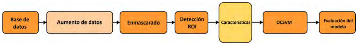
Figura 1: Metodología de entrenamiento del algoritmo de detección OCSVM.
