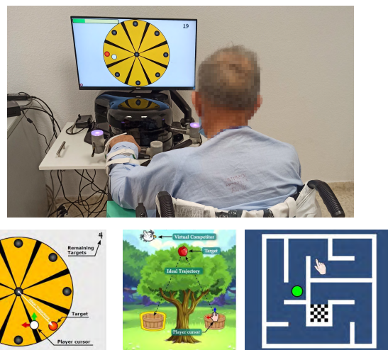
Figura 1: Imagen de un usuario empleando el robot Rubidium durante una terapia de neurorehabilitación. En la Figura también se han representado algunos de los juegos incluidos con el dispositivo.
