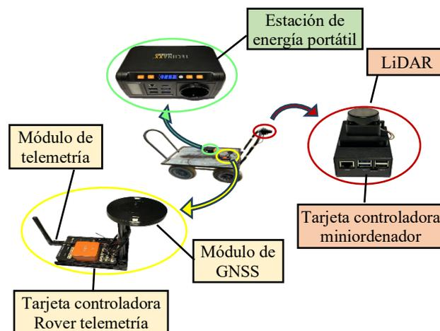
Figura 1. Carretilla con los elementos del sistema experto: de navegación (amarillo), de control y mapeo de la estructura de la vegetación (rojo) y estación de energía portátil (verde).
