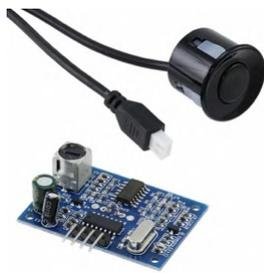
Figura 2. Sensor de ultrasonidos (Sensor + placa amplificadora)
