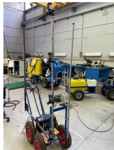
Figura 1. Carretilla pulverizadora.
