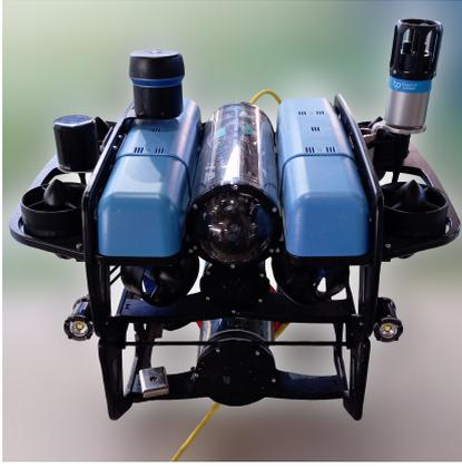
Figura 3: Configuración del vehículo BlueRov2 Heavy tras añadir distintos accesorios y sensores.
