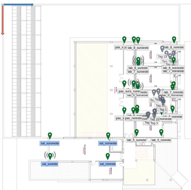
Figura 2: Distribución de sensores y receptores de localización en la primera planta del edificio CIESOL.
