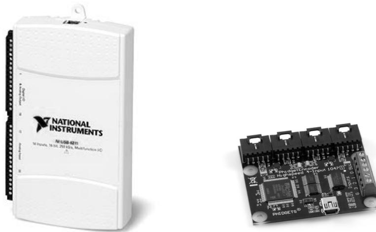
(a) Tarjeta de adquisición de datos NI-USB-6211
