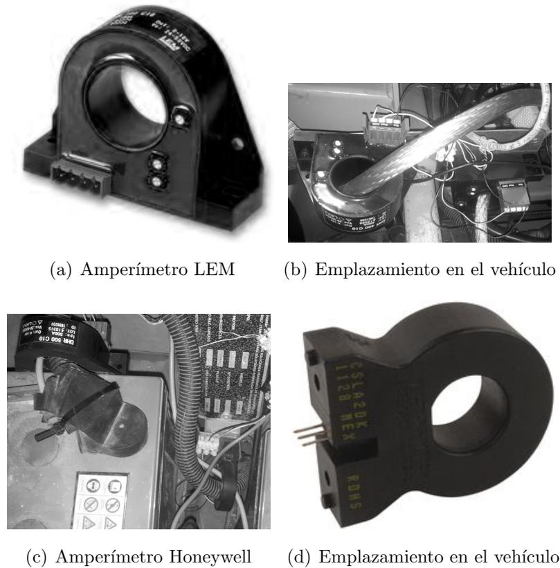
Figura 6.8: Descripción de sensores: Amperímetros
