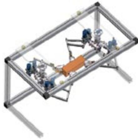
Figura 5: Configuración para manipulación bimanual. Estructura auxiliar de aluminio.
