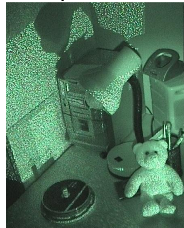
Figura 2. Ejemplo de patrón de puntos proyectado.
