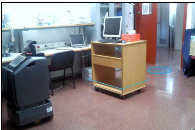
Figura 10. Escenario de realización de una de las pruebas. Las líneas azules indican a qué altura percibe la mesa el escáner 2D, y el círculo indica la posición de destino del algoritmo reactivo.
