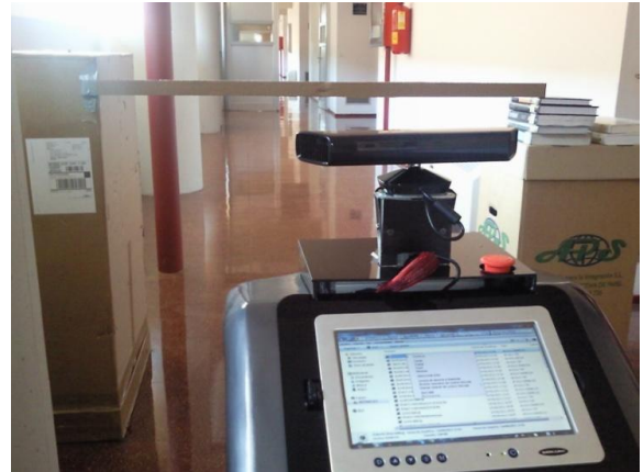
Figura 3. Proceso de prueba de la detección de Kinect de objetos finos. En este caso el objeto longitudinal es de 4cm de grosor.
